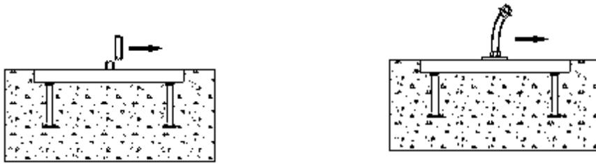
(d) 平行剪力作用下的 T 型螺栓破坏 (e) 平行剪力作用下的 T 型螺栓弯曲破坏
