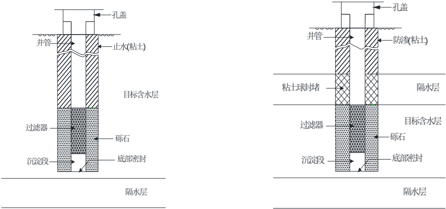
图 4.2.1-1 潜水水位观测孔示意图 图 4.2.1-2 承压水水头观测孔示意图
