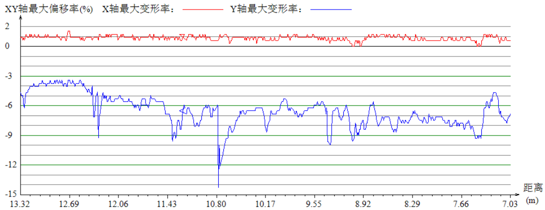
图 3 管道 X 轴和 Y 轴上最大变形率曲线图示例
