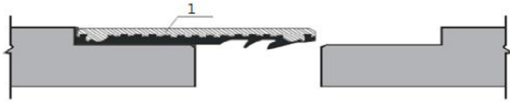
图 4.6.4-2 有内水压双插口接头
