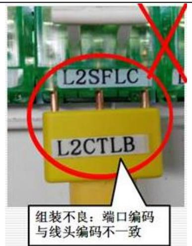
图13-4 检查照明分电器端口标签与线头标签是否一致示例
