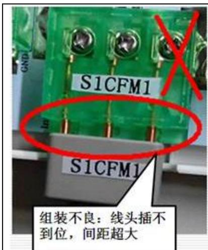
图13-1 检查插座分电器端口线头是否安装到位示例
