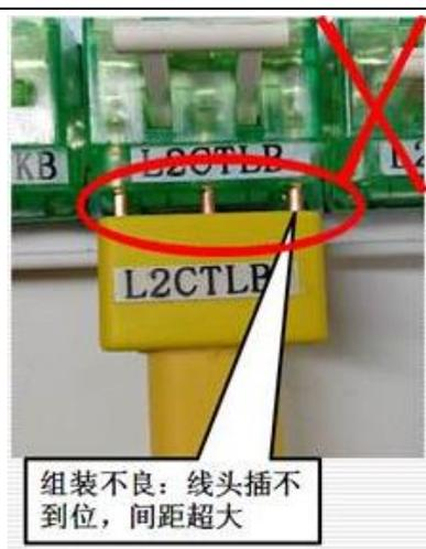
图13-2 检查照明分电器端口线头是否安装到位示例
