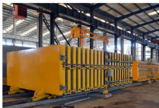
(c) 成组立模生产桁架预制板
