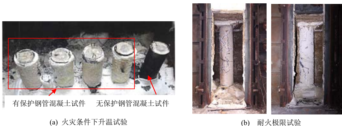
图 7.0.4 采用膨胀型防火涂料的钢管混凝土试件破坏形态
