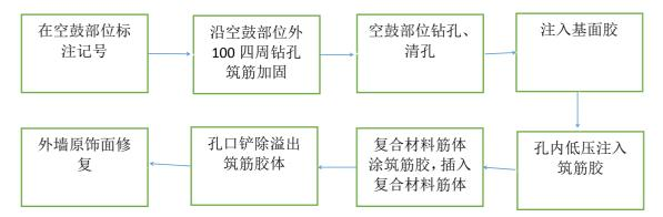
条文说明: 7.2.1 本条介绍了注浆筑筋修缮工艺的施工流程。
