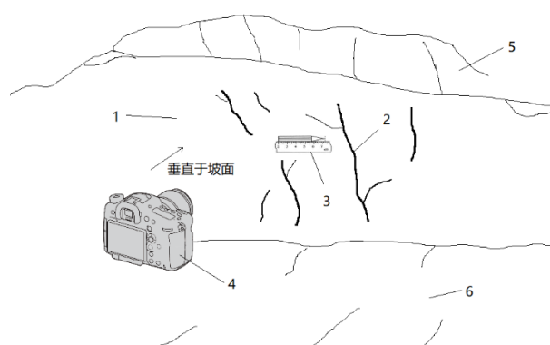
图 24.3.8 摄影图像法测试裂隙示意图
