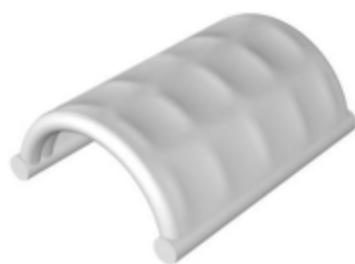
（b）用张拉膜覆盖气肋拱架
