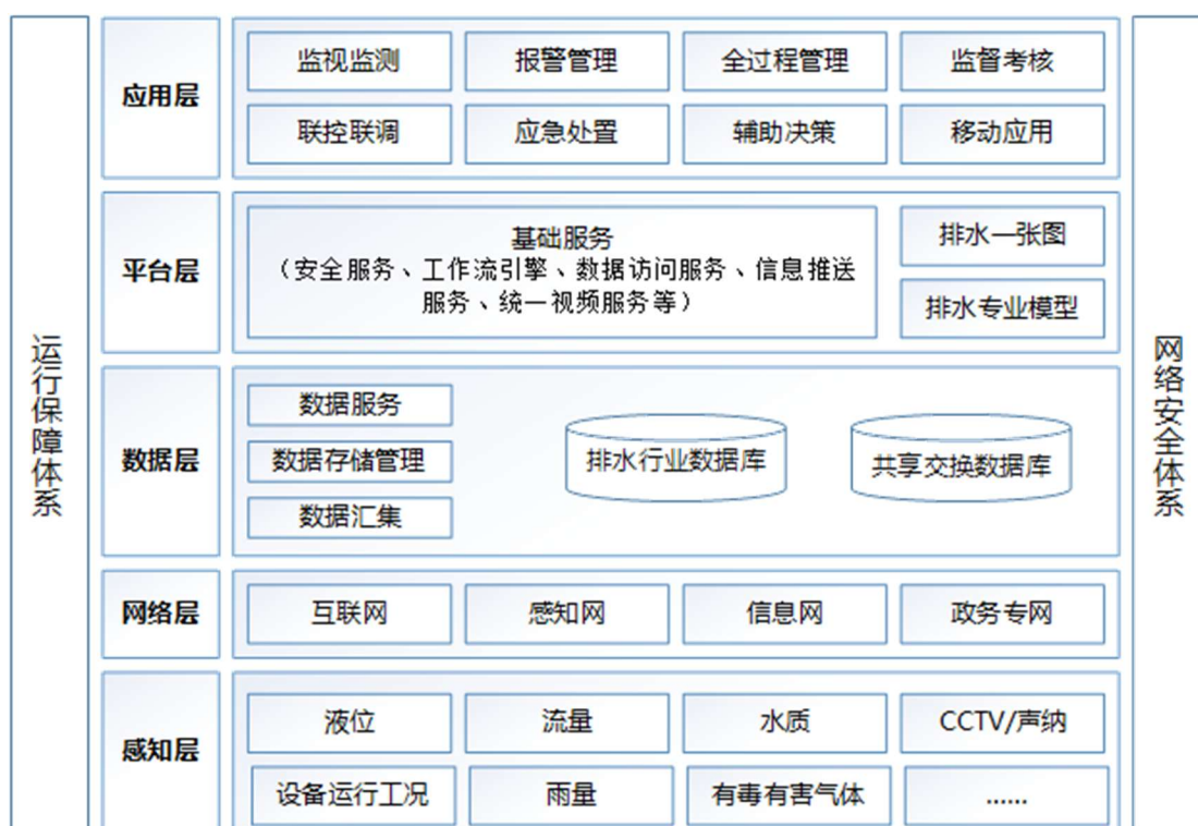
图 5.5.7-1 信息化建设监控平台系统结构示意图
