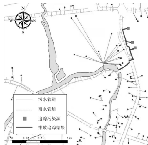
图 B-2 单个污染源下溯追踪结果
