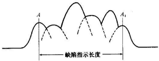
图 6.2.16 端点峰值测长法
