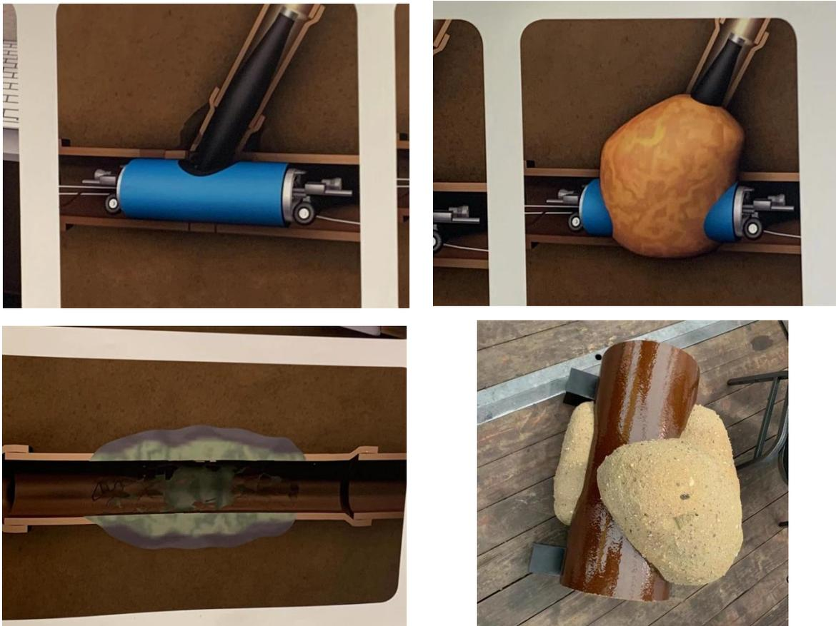
图 1 气囊注浆示意图。
