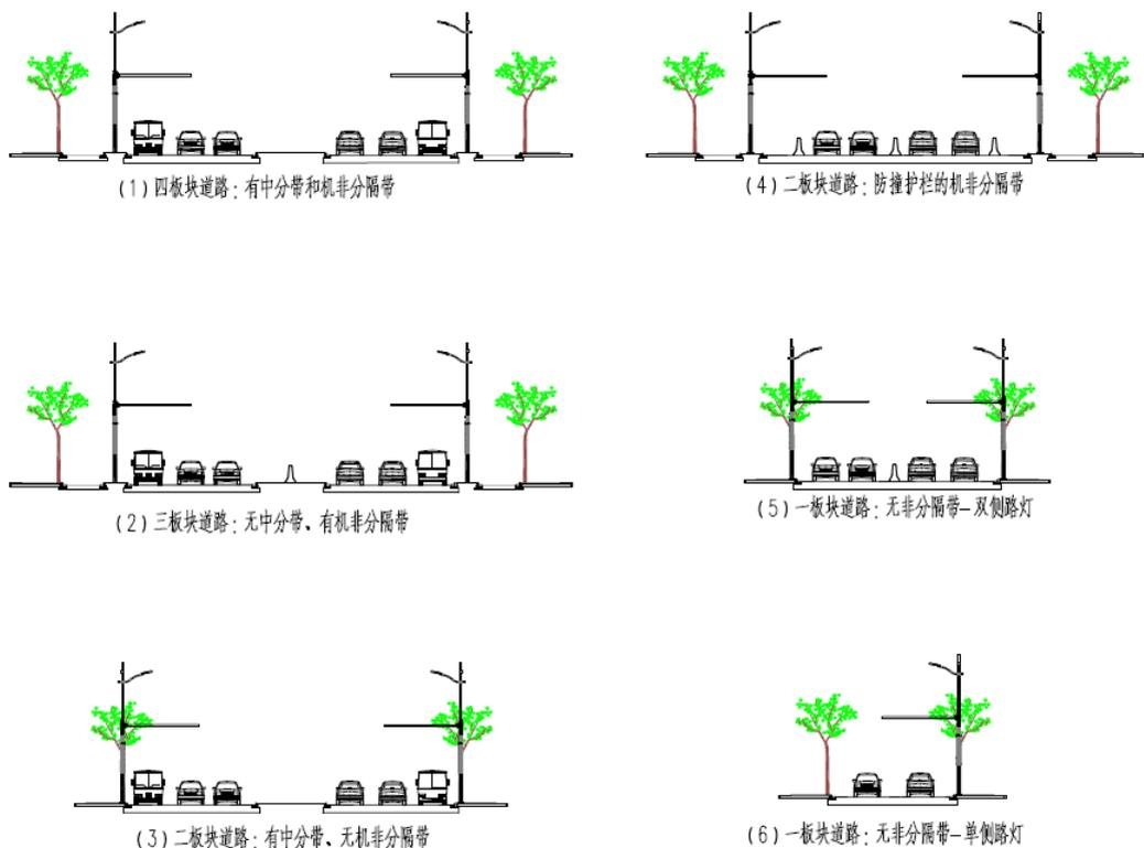
图A-1 典型横断面智慧综合杆布设示例
