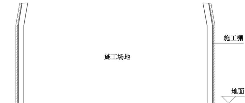
图 2.0.3-1 半封闭式施工棚断面示意图
