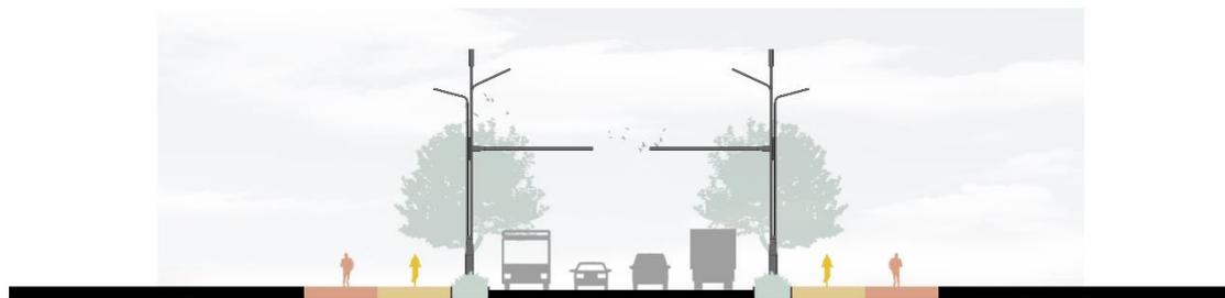
图 B.0.5 无分隔带、双侧路灯
