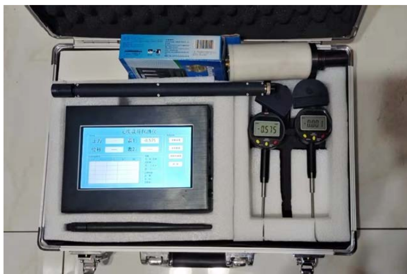
图 4.1 无缆螺旋板载荷试验数据采集仪
