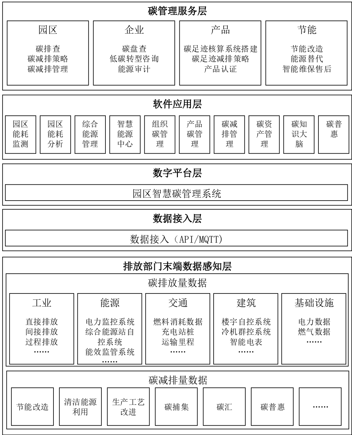
图 4.2.1 园区智慧碳管理系统组成架构图
