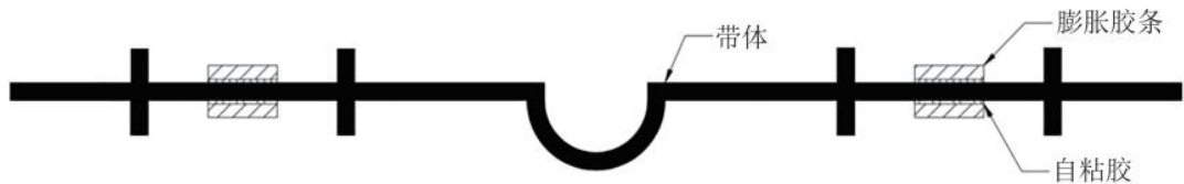
图 3 中埋式复合遇水膨胀胶条塑料止水带结构示意图
