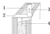
1—地下墙体；2—预埋件；3—端头钢管；4—锚固钢筋
