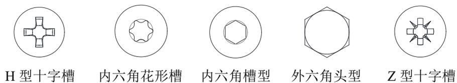
图 3.0.4 自攻螺钉扳拧结构类型
