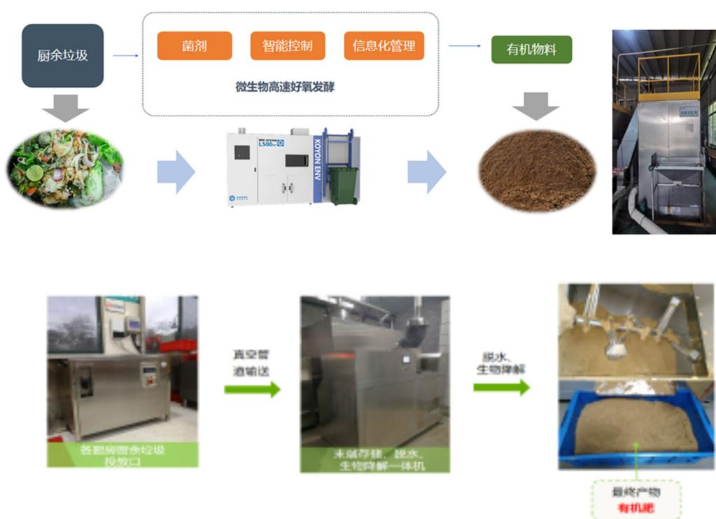
2 在机房设置固定的垃圾收集罐，增加脱水设备和油水分离器设备，厨余垃圾做脱水减量化处理；处理减量后的半干颗粒状厨余垃圾在垃圾桶中暂存，每天由第三方收运公司收集至市政大型垃圾处理厂进一步资源化处理。
