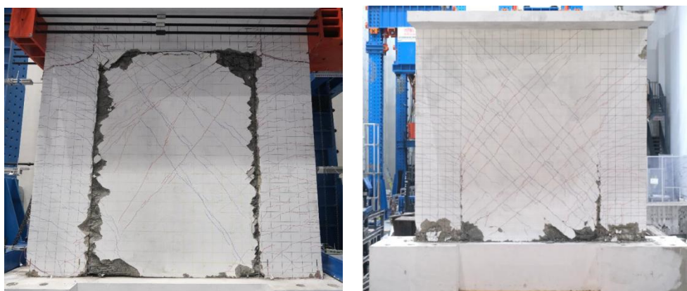
a) 剪力墙设置柔性分隔
