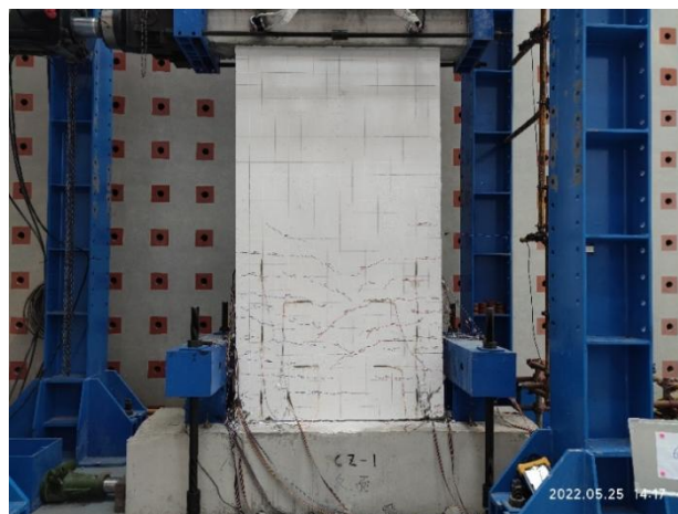
图9 墙模侧剪力墙试件破坏图
